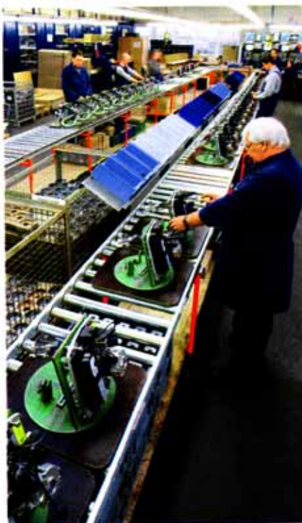
Bild 6 · Serienfertigung des Raketenbrenners RE 1H bei der MHG Heiztechnik GmbH in Hamburg.
