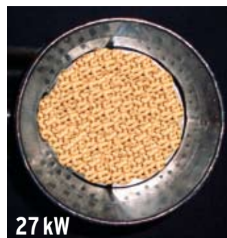
■ Bild 2: Zur gleichmäßigen Gemischaufbereitung sind die Luftdurchlässe im Brennrost mit unterschiedlichen Querschnitten versehen. Je nach Leistungsanforderung werden abgestimmte Brennstoffmengen zugeführt.
