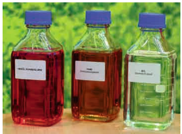
■ Bild 3: Durch den Klimawandel und der in Zukunft zu erwartenden Erschöpfung fossiler Energieträger werden die Entwicklungen im Bereich von Bio-Brennstoffen vorangetrieben (v. l. n. r.): schwefelarmes Heizöl, FAME (Fettsäuremethylester), BTL (Biomass to liquid). Bild: IWO
