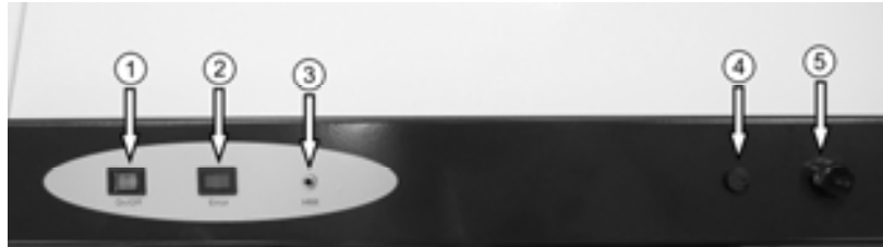
Abb. 3: Kesselschaltfeld mit Sicherheits- und Funktionselementen
